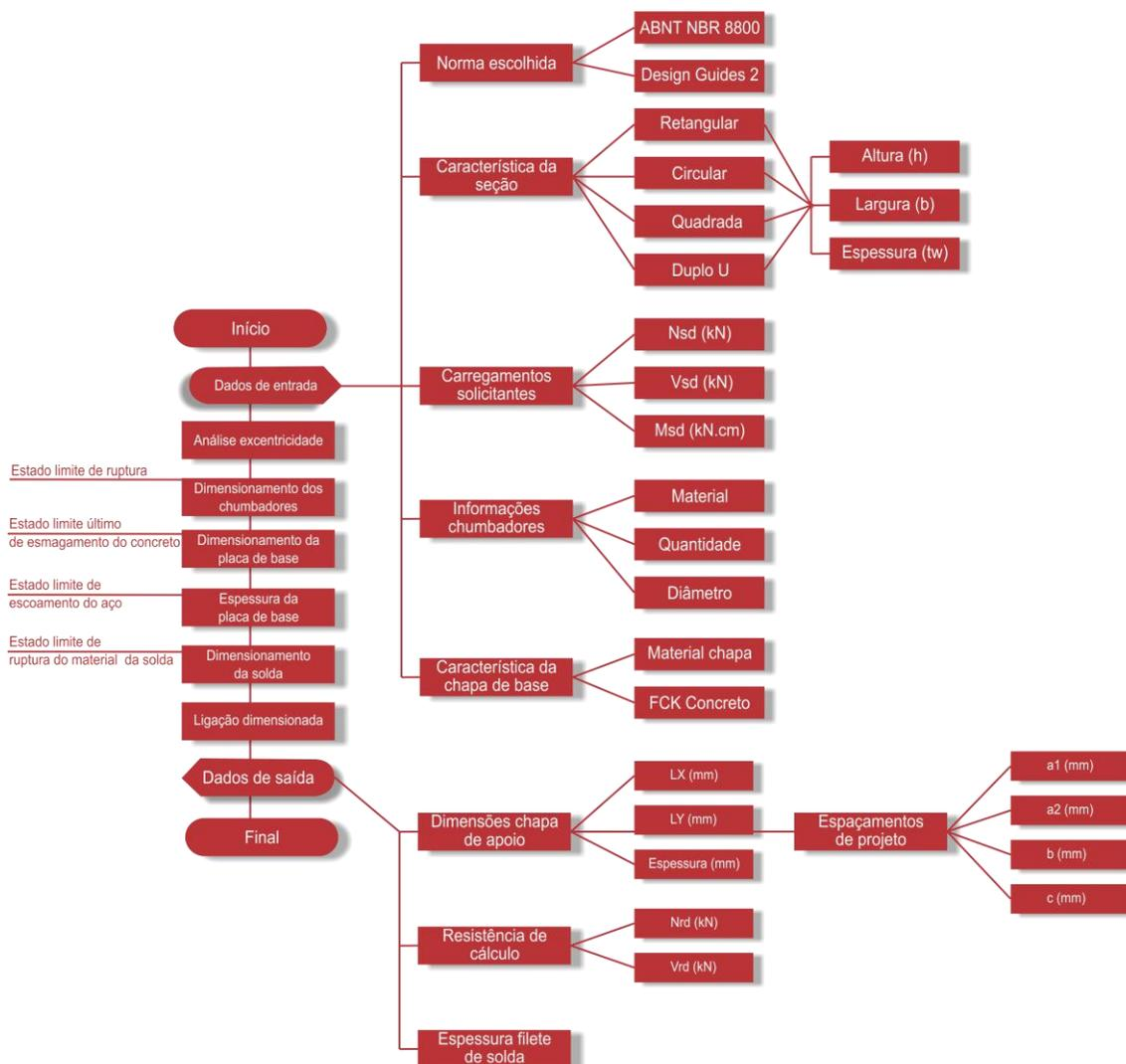
Figura 18 – Fluxograma de funcionamento do programa computacional
