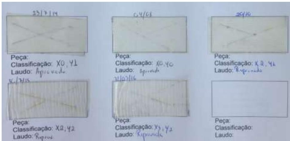
**Figura 27: Resultados os ensaios de aderência – NA12C**
