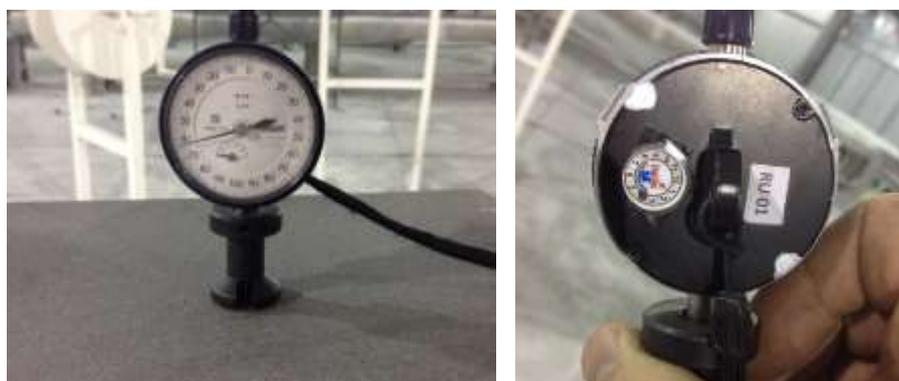
Figura 5: (Esq.) Medição de rugosidade e (Dir.) rugosímetro
