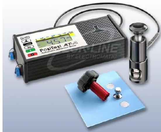
Figura 01: Equipamento de pull off
