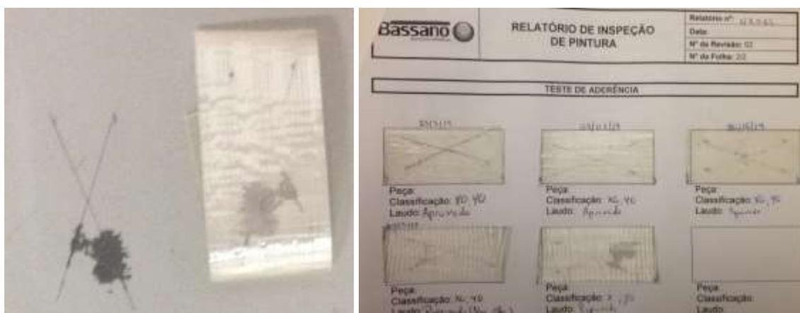
**Figura 18: (Esq.) Ensaio de aderência (31/05) e (Dir.) ensaios de aderência**
