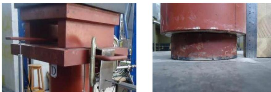
Figura 5 - Condições de contorno: (a) atuador; (b) base;
