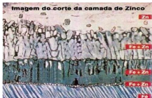
**Figura 2 - Imagem do corte da camada de Zinco sobre o aço após galvanização.**
