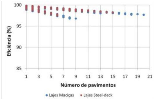
Figura 24 - Eficiência dos pilares de perfis em aço AR345.
