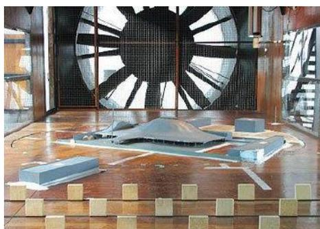
Figura 3. Simulação com modelo reduzido em túnel de vento. Fonte: [techne.pini.com.br](http://techne.pini.com.br)
