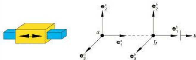
Figura 15 - Conexão do tipo *Translator* (fonte: SIMULIA [13]).
