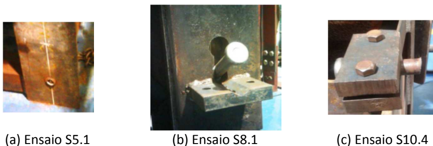
Figura 16. Exemplos de resultados dos ensaios de cisalhamento direto para diferentes pernas de solda.
