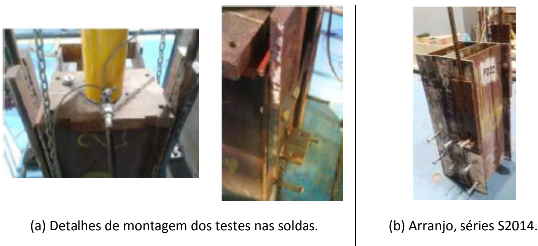
Figura 8. Detalhes dos ensaios de cisalhamento direto dos conectores.
