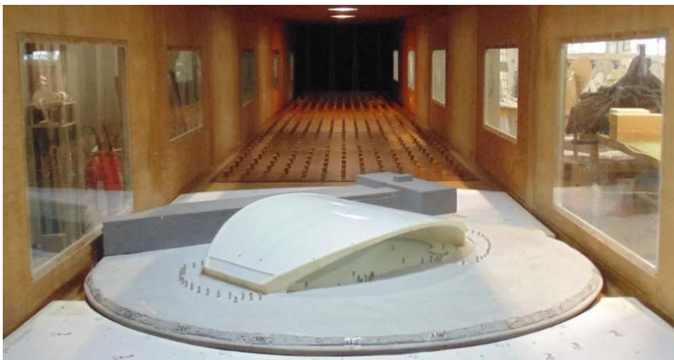
Figura 2 – Modelo da cobertura no interior do túnel de vento.
