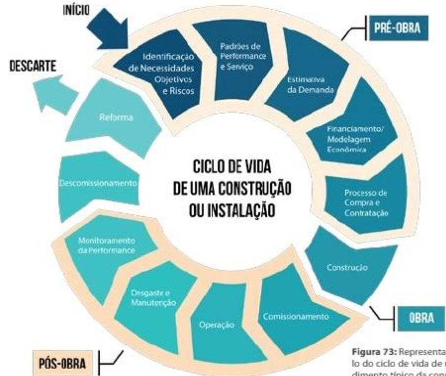
Figura 73: Representação em bloco do ciclo de vida de um empreendimento típico da construção.
