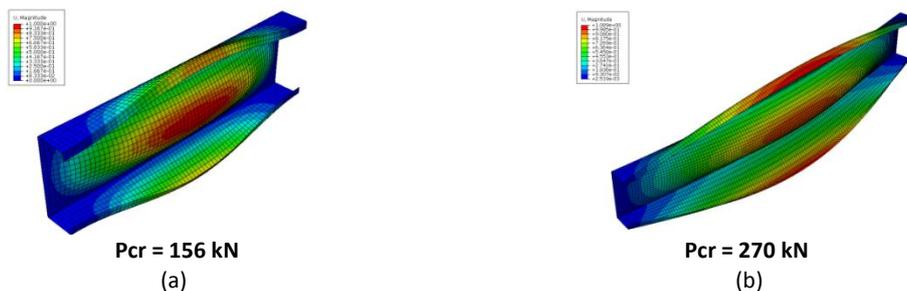
Figura 3.10 – Primeiro dos modos de instabilidade distorcional, MD: (a) vigésimo modo de instabilidade para  $L=70$ cm e (b) trigésimo primeiro modo de instabilidade para  $L=150$ cm.
