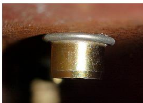
d) Detalhe do rebite já instalado
