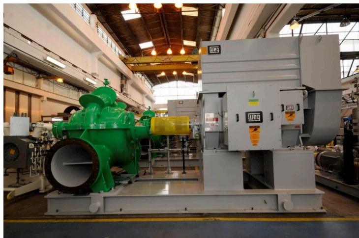
Figura 01 - Conjunto moto-bomba. Fonte: KSB Bombas.
