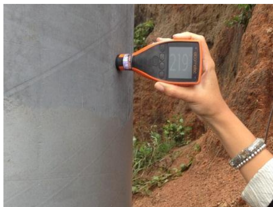
Figura 6 – Medidor de espessura de camada de revestimento de zinco sobre o substrato de aço.
