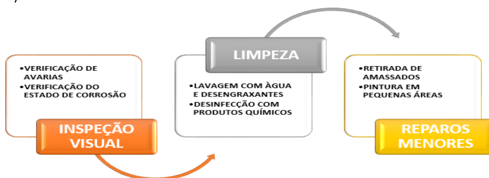
Figura 4: Inspeção do container. Fonte: Elaborado pelos autores.
