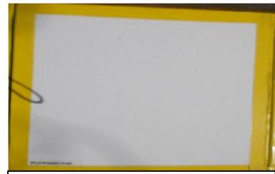
Acrílico a base d'água com acabamento poliuretano 1 mês de exposição natural. Material intacto e sem defeitos. No teste de fogo manteve a resistência ao fogo.
