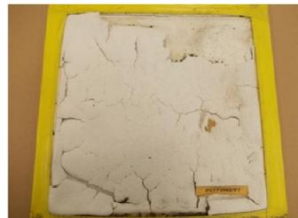
Acrílico a base d'água 6 meses de exposição natural. Material sofreu total deterioração do filme – craqueamento e escamação
