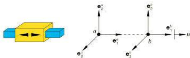
Figura 15 - Conexão do tipo Translator (fonte: SIMULIA [13]).
