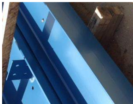
Figura 08: Interseal 1509 (não apresenta manchamento)
