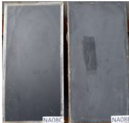
Figura 20: Corpos NA08 (C) não exposto e (E) exposto - (31/05)
