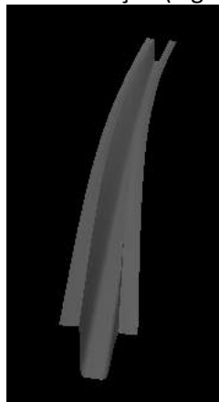
Figura 18 – Modo de instabilidade visualizado no GBTUL (flambagem lateral com torção).
