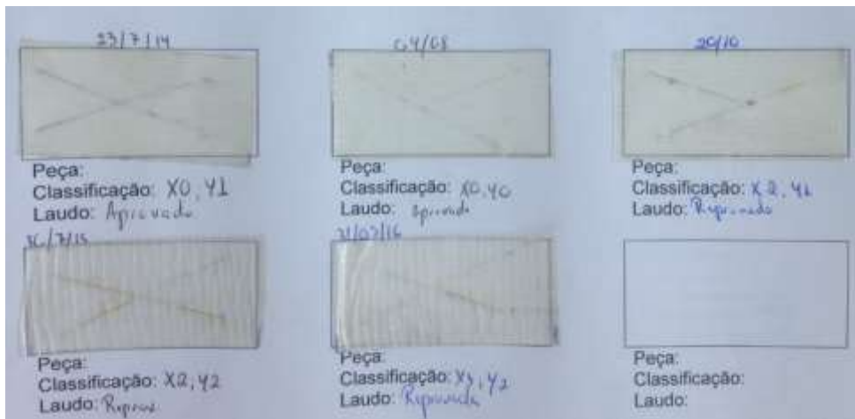
Figura 27: Resultados os ensaios de aderência – NA12C
