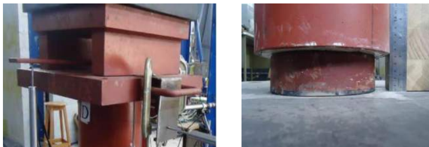
Figura 5 - Condições de contorno: (a) atuador; (b) base;
