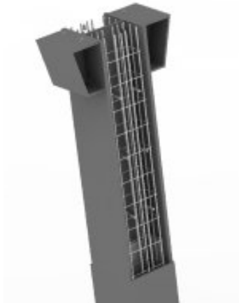
Figura 10: Estrutura em 3D dos consolos para apoio das vigas.
