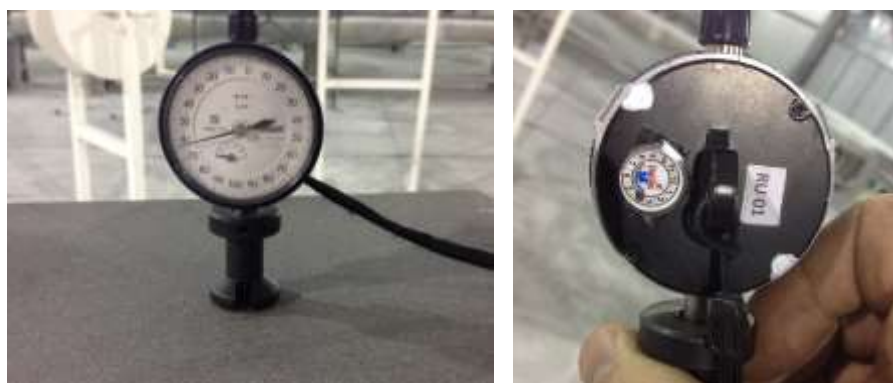
Figura 5: (Esq.) Medição de rugosidade e (Dir.) rugosímetro
