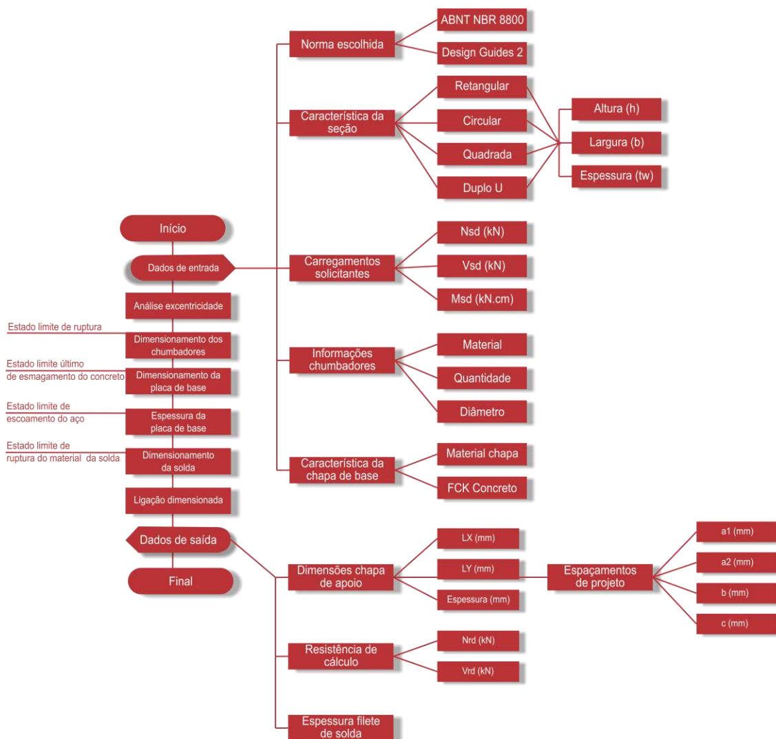
Figura 18 – Fluxograma de funcionamento do programa computacional Fonte: Autora
