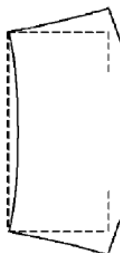
Figura 1: Deformações da seção transversal no modo distorcional para caso de compressão axial.
