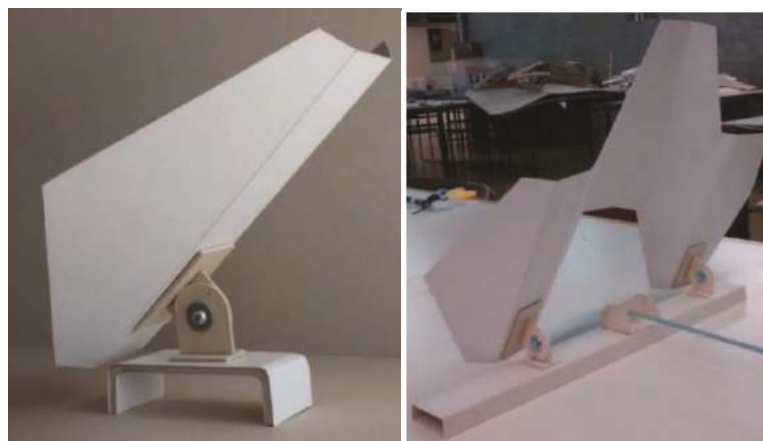
Figura 6 – Esquema do apoio rotativo na placa inferior e esquema da protensão.
