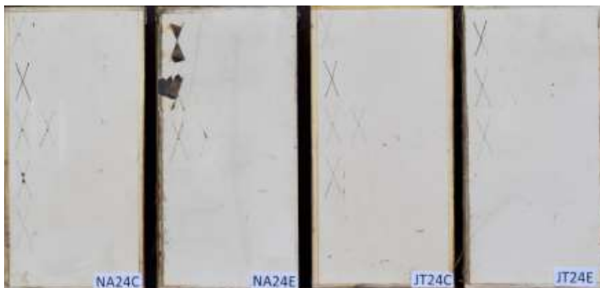
Figura 43: Corpos de prova com a mesma camada de película seca (240 \mu\text{m} ) - (31/05)
