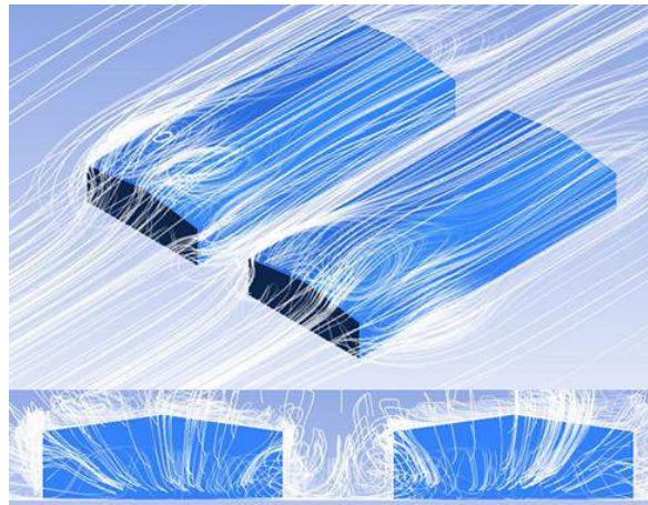
Figura 28 – Visualização das linhas de fluxo do escoamento para o Modelo 05
