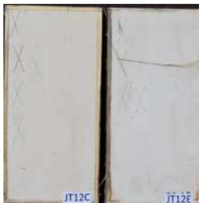
Figura 29: Corpos JT12 (C) não exposto e (E) exposto - (31/05)
