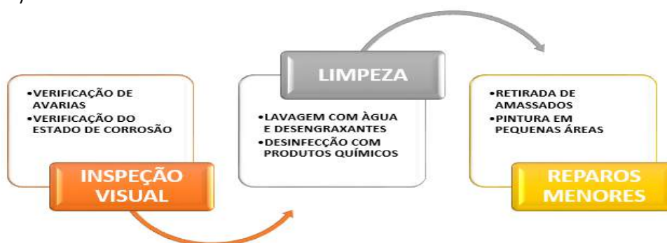
Figura 4: Inspeção do container. Fonte: Elaborado pelos autores.
