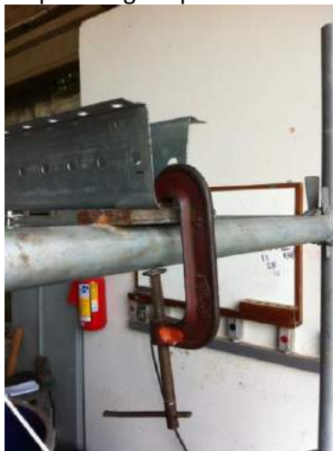
Figura 23 – Apoio de extremidade – chapa plana com grampo de fixação (Laboratório de Estruturas da UNICAMP).
