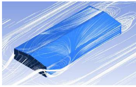
Figura 10 – Visualização das linhas de fluxo do escoamento para o Modelo 01
