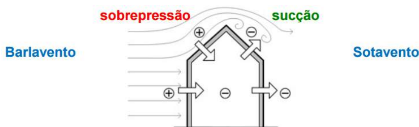
Figura 4 – Ação externa do vento em edificações. Fonte: aquarius.ime.eb.br
