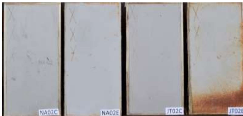
Figura 17: Corpos de prova com a mesma camada de película seca ( 20\mu\text{m} ) - (31/05)
