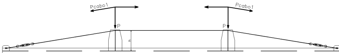
Figura 11 – Decomposição de forças ao longo dos cabos. (Fonte: Elaborada pelo autor)
