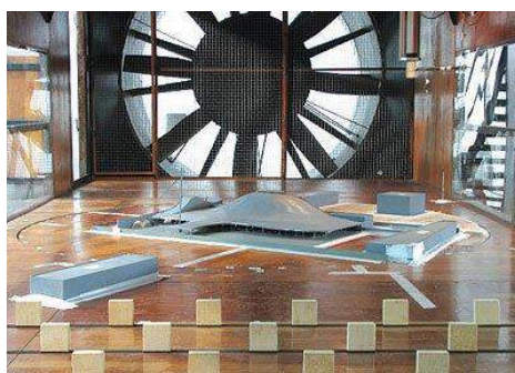
Figura 3. Simulação com modelo reduzido em túnel de vento. Fonte: techne.pini.com.br
