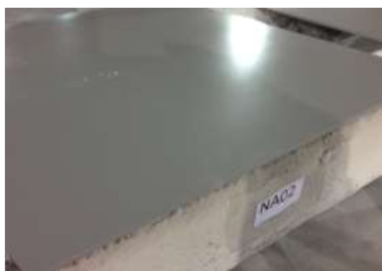
Figura 7: Corpo de prova NA02 pintado
