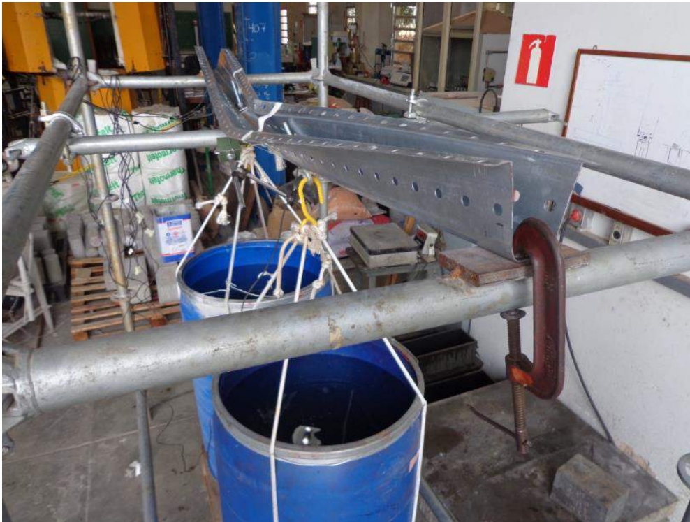
Figura 7 – 2º Ensaio após colapso – flambagem lateral com torção (Laboratório de Estruturas da UNICAMP).
