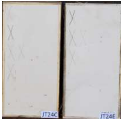
Figura 41: Corpos JT24 (C) não exposto e (E) exposto - (31/05)
