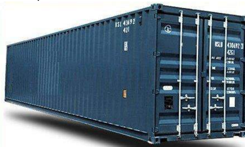
Figura 2: Container 40 pés, 2TEU's. Fonte: Containers Brasil [10].
