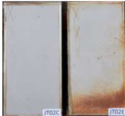
Figura 15: Corpos JT02 (C) não exposto e (E) exposto - (31/05)
