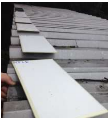
Figura10: Exposição dos corpos de prova
