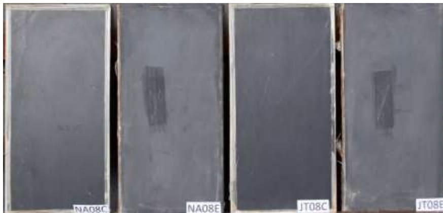
Figura 24: Corpos de prova com a mesma camada de película seca ( 80\mu\text{m} ) - (31/05)
