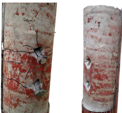
Figura 9 - Modelos experimentais após a ruptura
