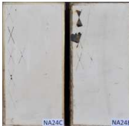
Figura 39: Corpos NA24 (C) não exposto e (E) exposto - (31/05)
