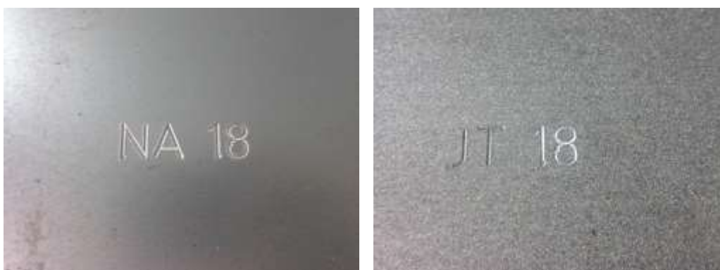
Figura 4: (Esq.) Corpo de prova sem preparação para pintura e (Dir.) corpo de prova após o jateamento abrasivo SA 2 ½
