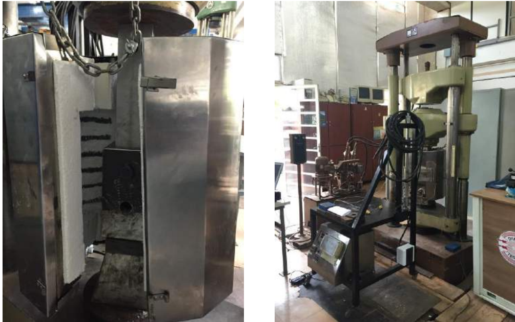
Figura 5 – Ensaio em temperatura elevada
