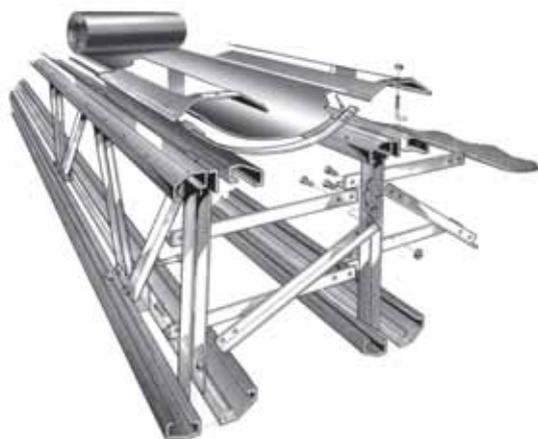
Roll-on é um Sistema Integrado de Estrutura e Cobertura Metálica, totalmente galvanizado, fabricado em série e com estoques permanentes para pronta entrega. Seu design compreende peças padronizadas e intercambiáveis, fáceis de transportar e montadas em linha de produção apenas com uma ferramenta.
