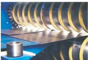
Figura 12 – Estação de corte
