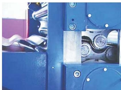
Figura 13 – Estação de conformação
