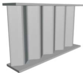
Figura 1 – Perfil de Alma Trapezoidal Fonte: de Hoop (2003)
