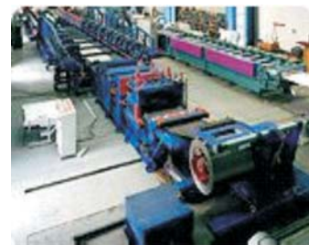
Figura 10 – Desbobinador Fonte: Site da Zeman & Co (1997) e Manual Técnico da Codeme Eng. SA (2005)
