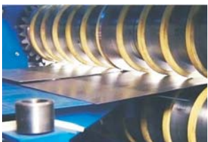
Figura 12 – Estação de corte
