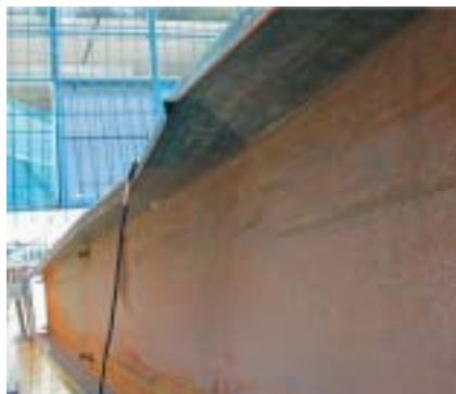
b) Falha ocorrida durante ensaio.
