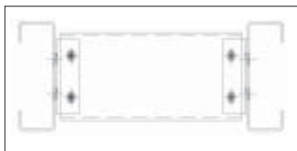
Figura 8: Travamento lateral entre perfis.
