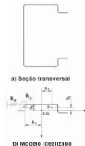
Figura 5: Modelo idealizado para a instabilidade por distorção.
