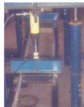
b) Falha em ensaio à flexão.
