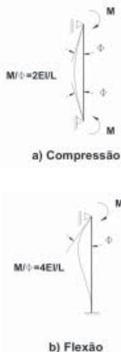
Figura 6: Apoios idealizados para as almas dos perfis.
