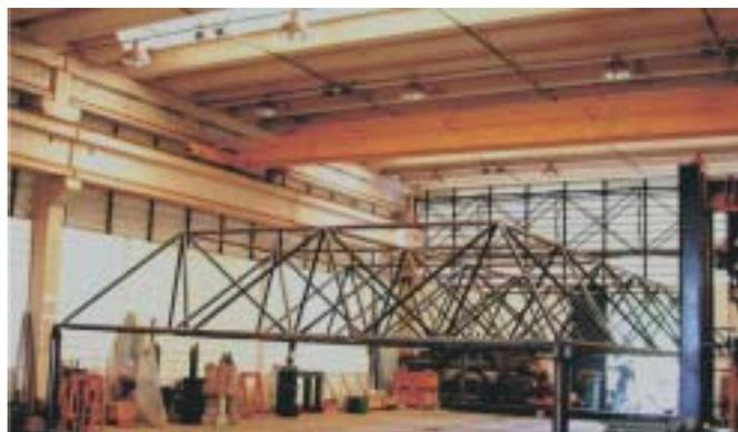
Figura 2 – Exemplos de treliças de quadrado sobre quadrado com defasagem de meio módulo
