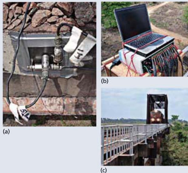
Figura 2 – Obtenção dos dados. a) Acelerômetros fixados à lateral do tabuleiro, em disposição triaxial. b) Sistema de aquisição de dados ADS-2000 Lynx conectado ao notebook. c) passagem do trem
