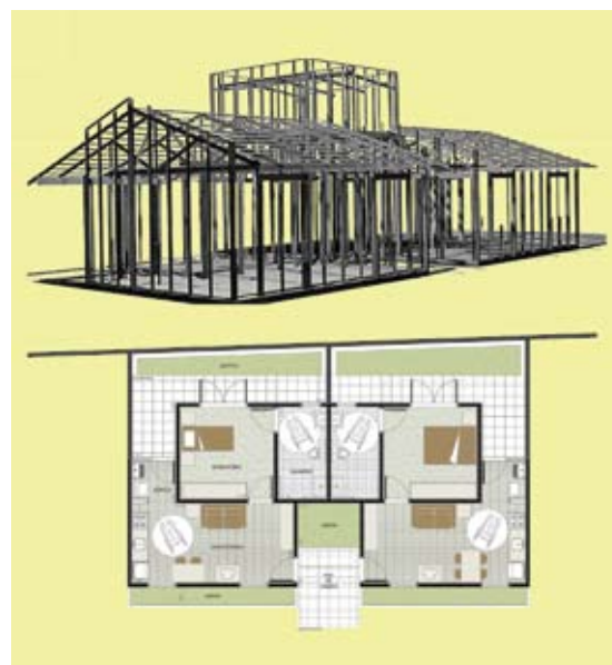
Estrutura Steel Frame e planta do projeto adaptada para uso de idosos
