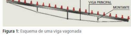
Figura 1: Esquema de uma viga vagonada
